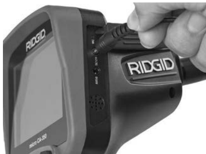
Obrázok č. 6 - Napájanie zariadenie pomocou AC adaptéru
